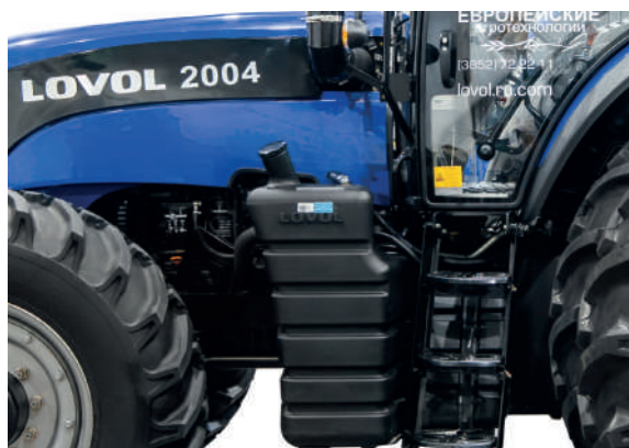
Топливный бак большой емкости на 350 л
