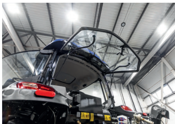
Заднее стекло кабины оснащено пневматическими амортизаторами
